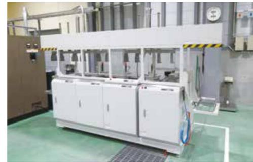
導入した設備「水系超音波洗浄システム」
